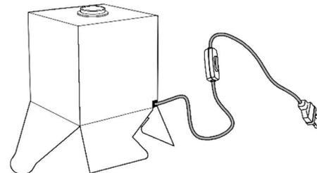
**9** | PASSER LE CÂBLE DANS L'INTERSTICE PRÉVU À CET EFFET À L'ARRIÈRE, EN PRENANT SOIN DE BIEN METTRE L'INTERRUPTEUR À L'EXTÉRIEUR
