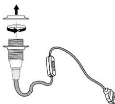
**5** | DÉVISSER ET RETIRER LA BAGUE SUPÉRIEURE ET LA METTRE DE CÔTÉ
