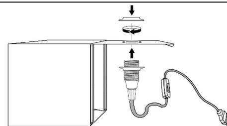
**6** | INSÉRER LA DOUILLE DANS LE ROND DU COUVERCLE DE LA BOÎTE ET Y REVISSER LA BAGUE SUPÉRIEURE
