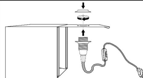
6 | INSÉREZ LA DOUILLE DANS LE ROND DU COUVERCLE DE LA BOÎTE ET REVISSEZ Y LA BAGUE SUPÉRIEURE
