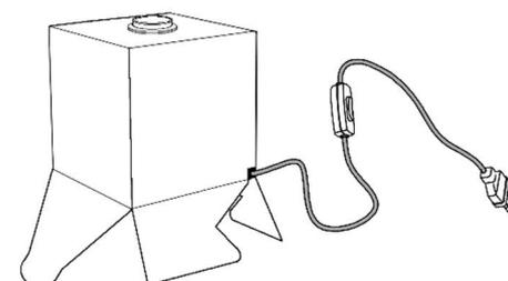
9 | PASSEZ LE CÂBLE DANS L'INTERSTICE PRÉVU À CET EFFET À L'ARRIÈRE, EN PRENANT SOIN DE BIEN METTRE L'INTERRUPTEUR À L'EXTÉRIEUR
