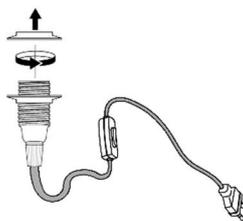
5 | DÉVISSEZ ET RETIREZ LA BAGUE SUPÉRIEURE ET METTEZ LA DE CÔTÉ
